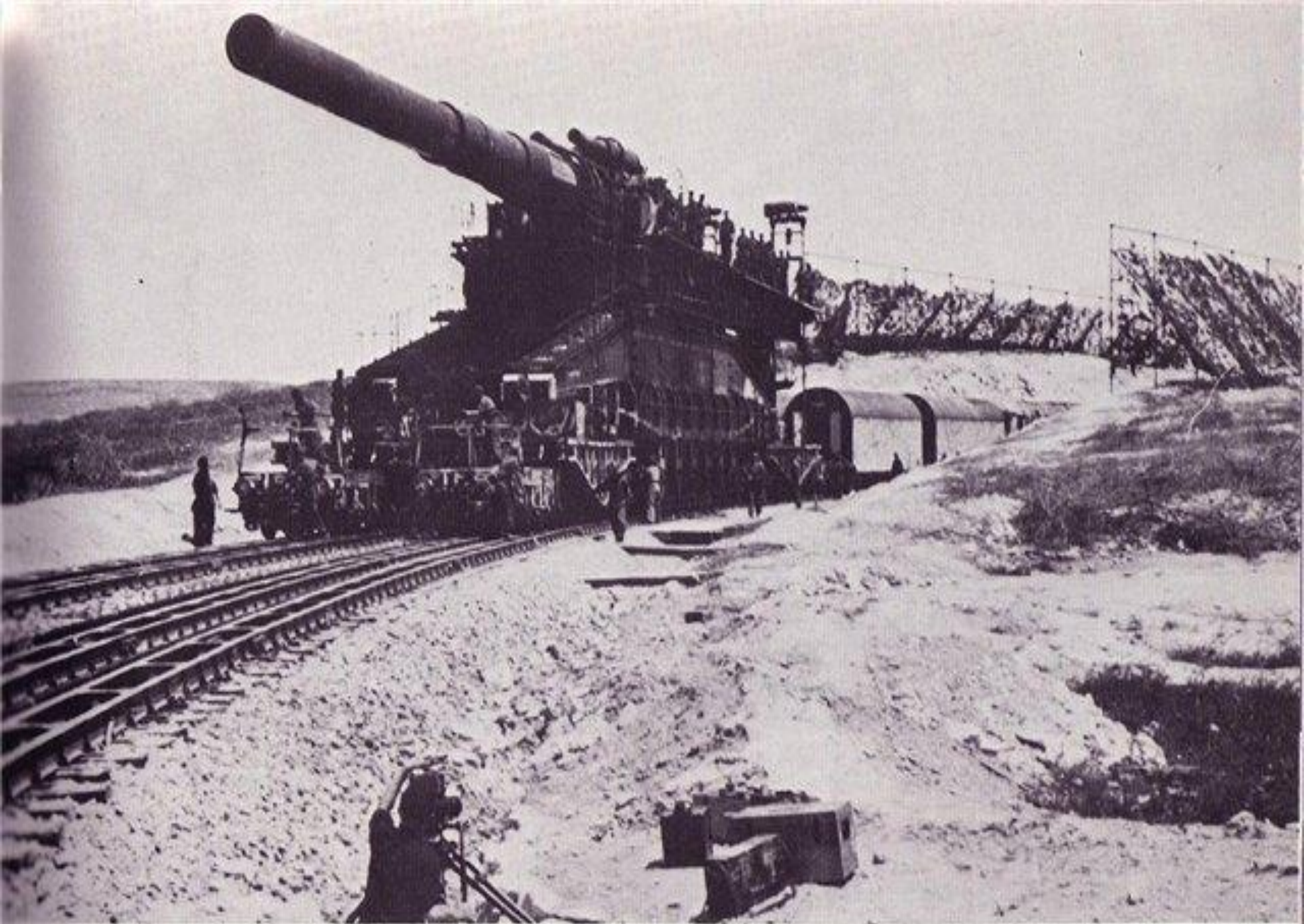
Schußposition in der Schießkurve. Munitions- und Kartuschwagen stehen hinter dem Geschütz, das Laden kann beginnen.
